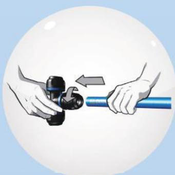
Mutter lockern und dann das Rohr durch eine leichte Drehbewegung bis zur Markierung in den Fitting einschieben.
