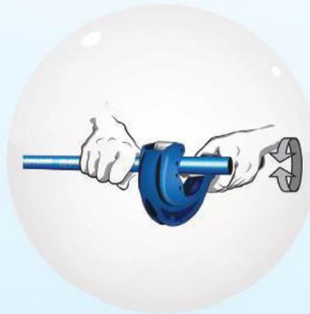
Der Rohrschnitt muss rechtwinklig zur Rohröffnung erfolgen (Bestellnr. PPS CTU)
