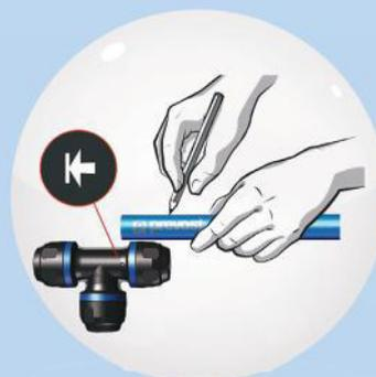
Das Rohr markieren, um die Einstecktiefe des Rohrs in den Fitting vor dem Festziehen kontrollieren zu können (hierzu die Markierungen an dem Fitting oder am Montageschlüssel heranziehen)
