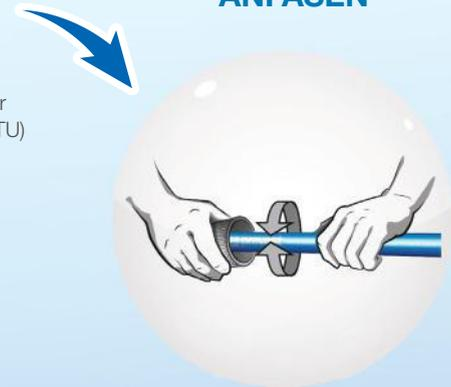
Rohraußenseite anfasen: das erleichtert das Einschieben in den Fitting und verhindert eine Beschädigung der Dichtung. Ein leichtes Anfasen der Rohrinneenseite beseitigt mögliche Schnittreste. (Für Ø 63 und 80 ist das Werkzeug PPS CTCHE6380 zum Schneiden und Anfasen zu verwenden).
